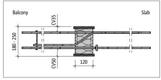
Fig. 64: Schöck Isokorb® XT type C-L-CV35: Product section
