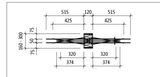
Fig. 275: Schöck Isokorb® XT type W-M1: Product plan view
