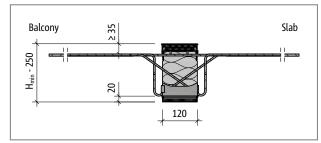
Fig. 34: Schöck Isokorb® XT type K-M5-VV1: Product section
