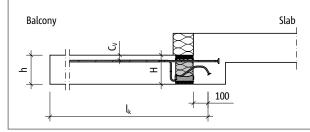
Fig. 97: Schöck Isokorb® XT type K-U: Static system
