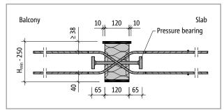
Fig. 161: Schöck Isokorb® XT type Q-P-VV1: Product section
