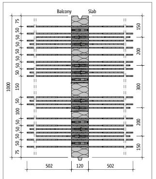
Fig. 36: Schöck Isokorb® XT type K-M5-VV1: Product plan view
