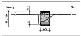
Fig. 30: Schöck Isokorb® XT type K-M5, M6: Product section
