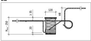
Fig. 78: Schöck Isokorb® XT type K-HV: Product section
